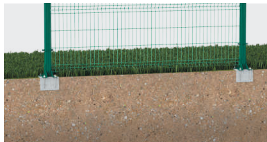
МОНТАЖ НА ГОТОВОЕ БЕТОННОЕ ОСНОВАНИЕ
